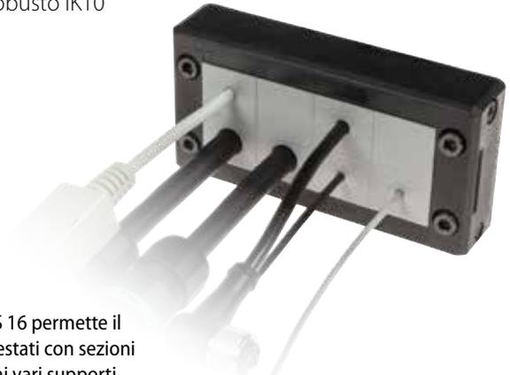
Il telaio divisibile DES 16 permette il passaggio di cavi intestati con sezioni da 2 a 34mm grazie ai vari supporti passacavo disponibili. La chiusura laterale del telaio permette la tenuta antistrappo e la protezione all'acqua.
