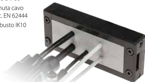
Il telaio divisibile DES 24 permette il passaggio di cavi intestati con sezioni da 2 a 34mm grazie ai vari supporti passacavo disponibili. La chiusura laterale del telaio permette la tenuta antistrappo e la protezione all'acqua.
